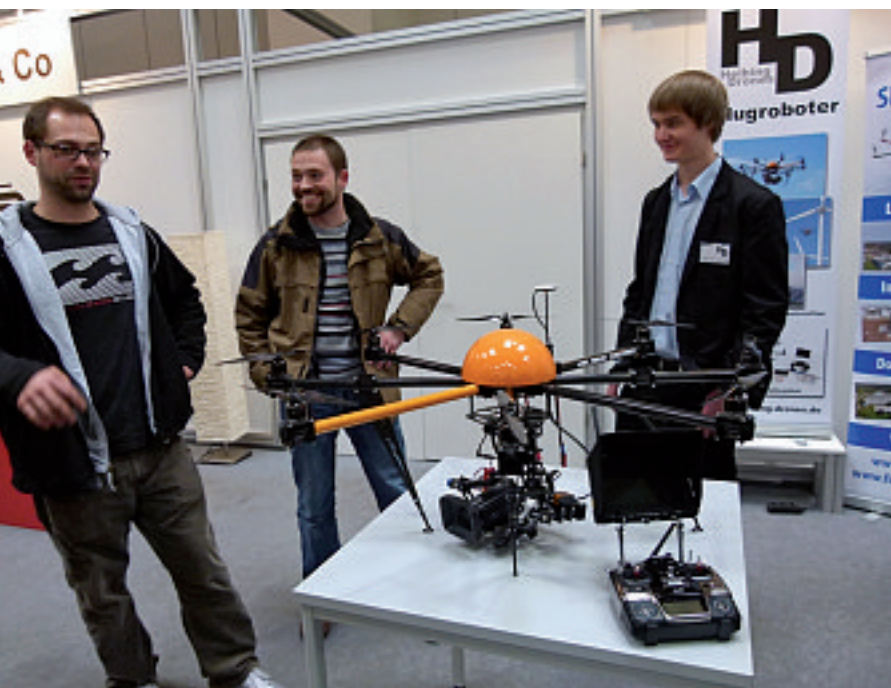
Auch an einem Oktokopter lassen sich Schäden durch einfaches Austauschen eines Rotors oder Antriebsmoduls binnen kürzester Zeit reparieren.
